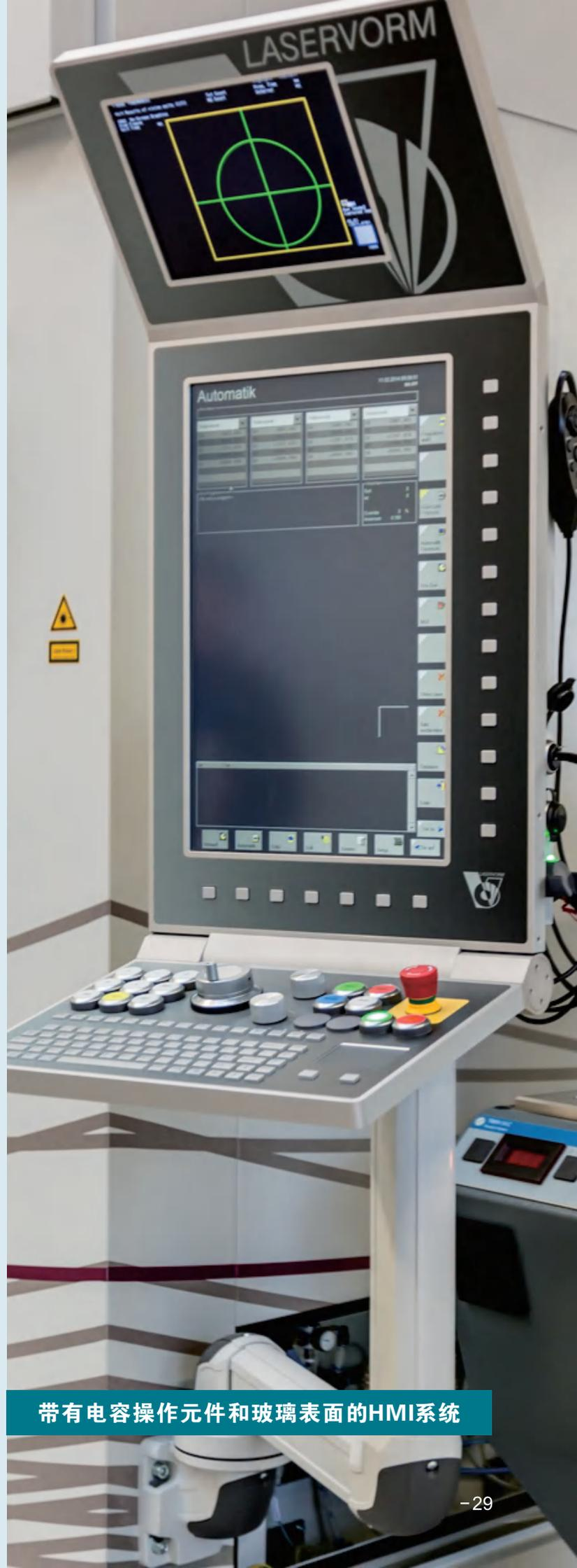
带有电容操作元件和玻璃表面的HMI系统
