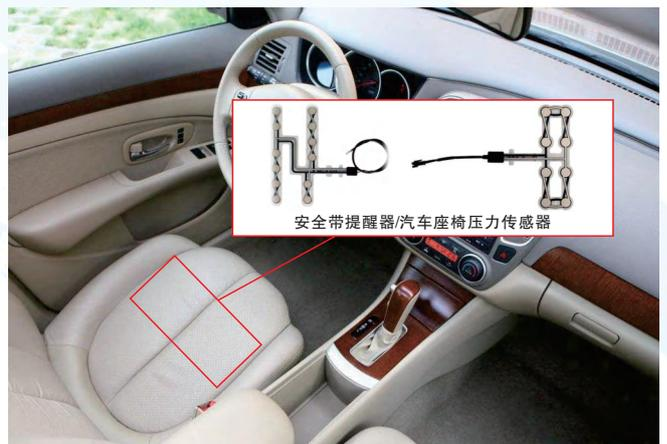
安全带提醒器/汽车座椅压力传感器
